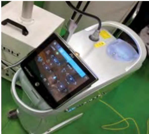
Figure 12: iPlus Waterlase laser (Er,Cr:YSGG).
